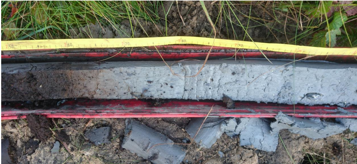
Boring 3 (250 – 310 cm –mv): veen, zeeklei en strandzand.
